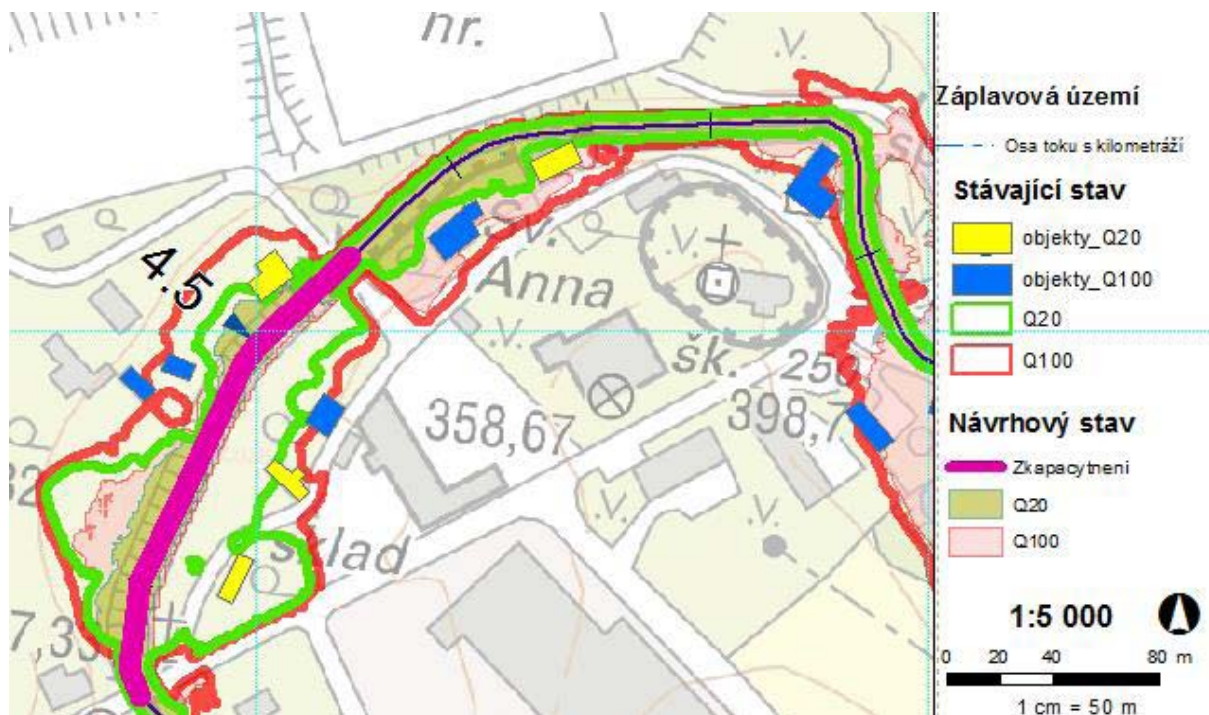
Obr. 33 Srovnání záplavového území pro současný stav a navrhovaný stav při povodních Q100 a Q20 v místě navrhovaného zkapacitnění koryta v Děťichově.
