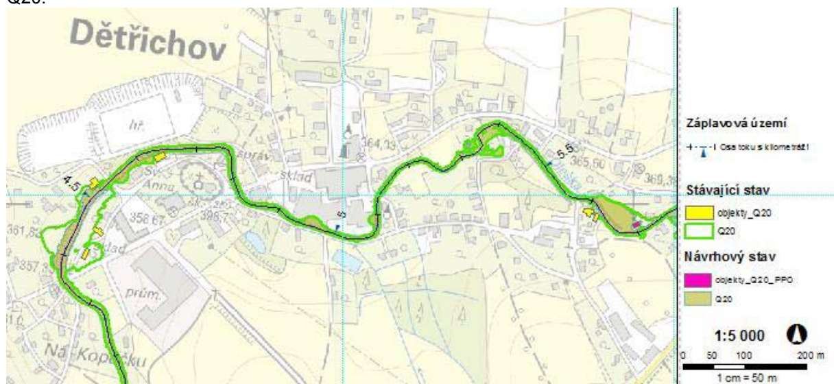
Obr. 32 Srovnání záplavového území pro současný stav a navrhovaný stav v Dětrichově při povodni Q20.
