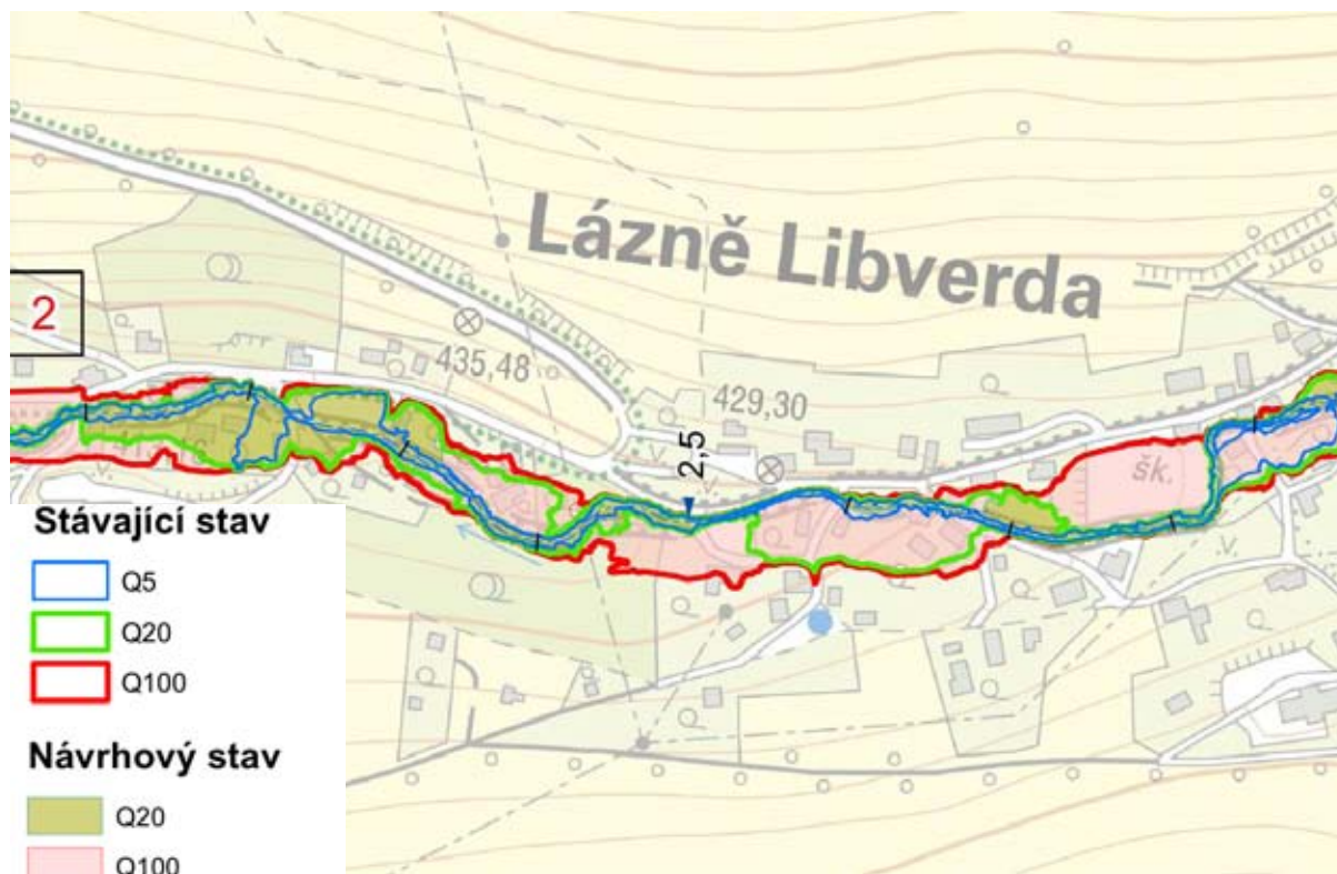
Obr. 49 - Výřez mapy zobrazující přepočítané odtokové poměry pro Libverdský potok v lokalitě u sportovního hřiště
